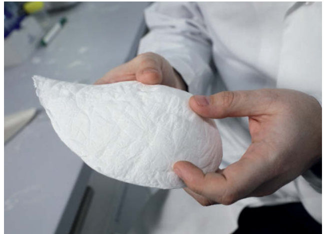
Объемный пористый имплант на основе полилактида, выполненный по форме части плевральной полости
