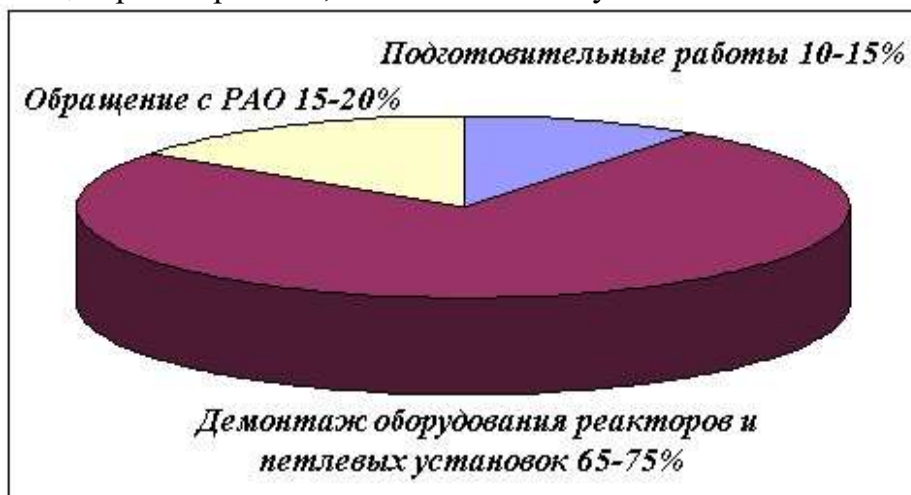
Рис.10. Оценка трудозатрат на основные виды работ при выводе из эксплуатации реакторов МР и РФТ.
