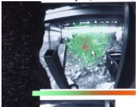
Рис. 8. Идентификация в массиве хранилища высокоактивных источников с помощью «Гаммавизора»
