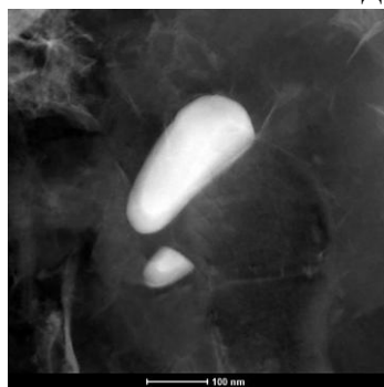
а – ПРЭМ-изображение карбидов типа Me_7C_3
