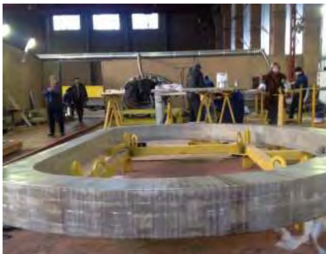
Рисунок 6.13 – Катушка ОТП после намотки и запечки
