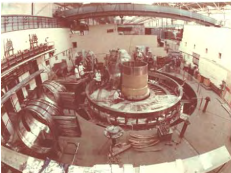
Рисунок 1.7 - Опорная колонна и катушки управления на штатном месте
