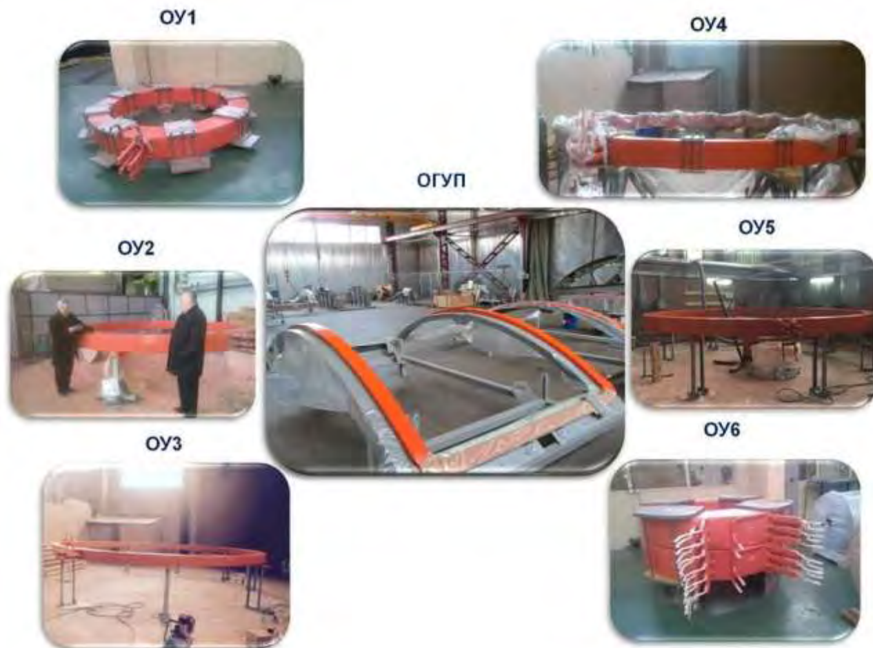
Рисунок 6.16 – Обмотки управления ОУ1-6 и катушки ОГУП
