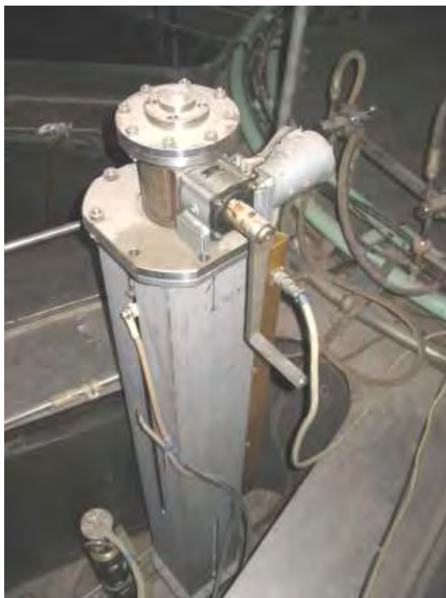
Рисунок 3.20 - Штырь тлеющего разряда на установке
