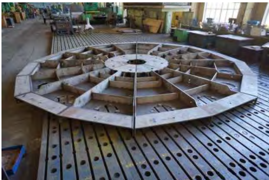
Рисунок 6.9 – Конструкция монтажной подставки (перевернута) на заводе ЭФО АО «НИИЭФА им. Д.В.Ефремова»
