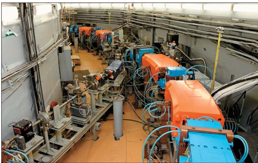
Рис.5. Один из суперпериодов ускорительно-накопительного большого кольца. Поворотные магниты показаны оранжевым цветом; одиночные квадрупольные линзы, дублеты и триплеты — синим; секступольные линзы — желтым. Видны каналы вывода СИ, проходящие сквозь биозащиту.
