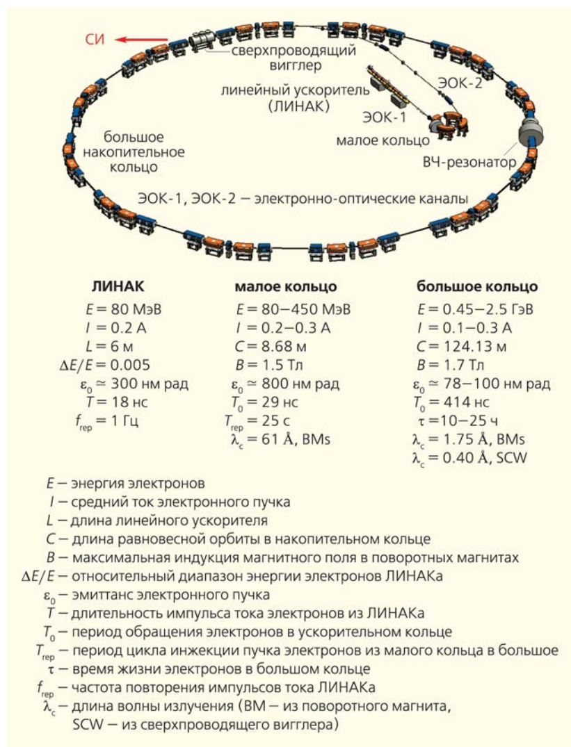
Рис.4. Ускорительно-накопительный комплекс источника СИ.
