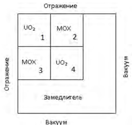
Рис. 1. Сектор симметрии двумерной конфигурации бенчмарка C5G7
