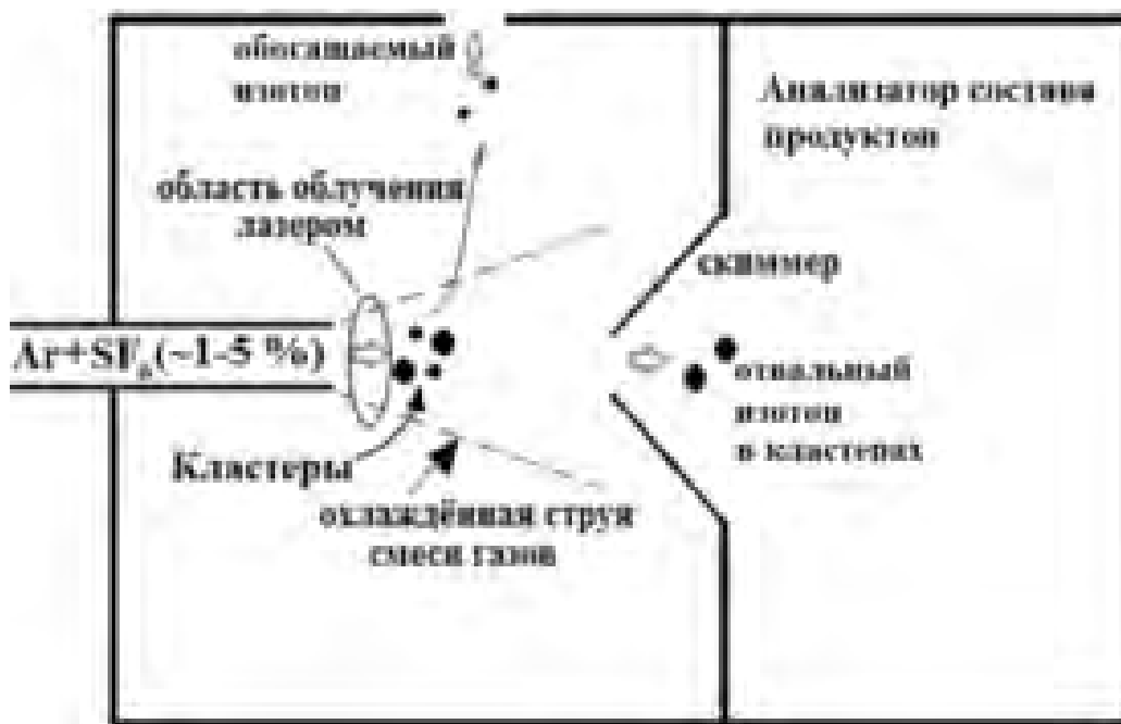
Рис. 2. Схематическое изображение процесса разделения изотопов методом селективного лазерного подавления кластерообразования.
