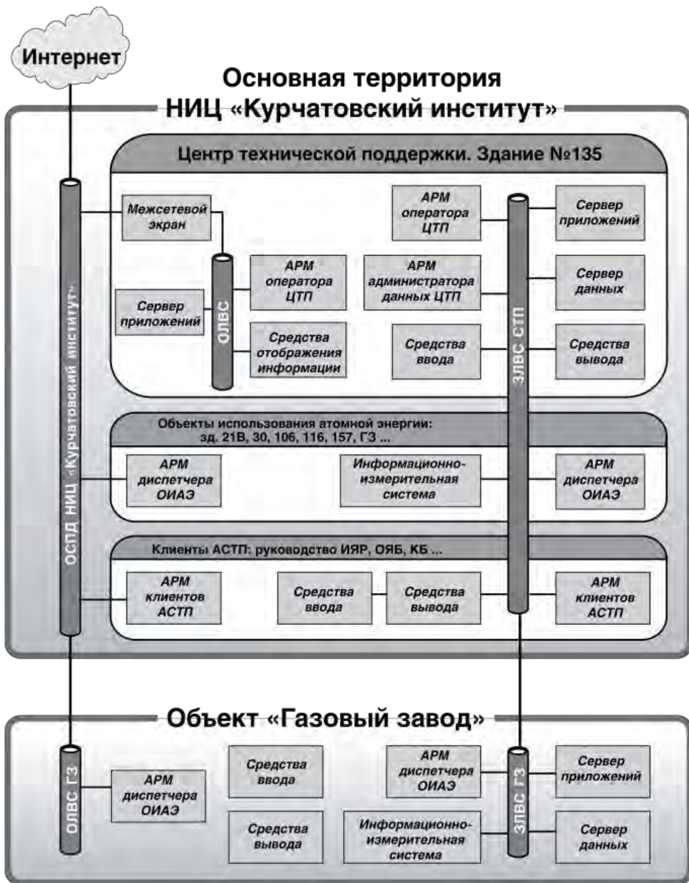
Рисунок 5 – Функциональная схема подключения компьютерного оборудования
