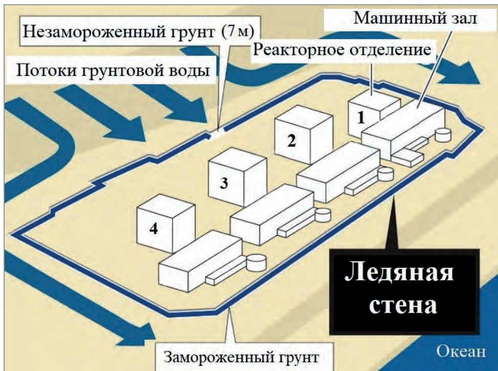
Рис. 6. «Ледяная стена», защищающая площадку с блоками от попадания грунтовых вод
