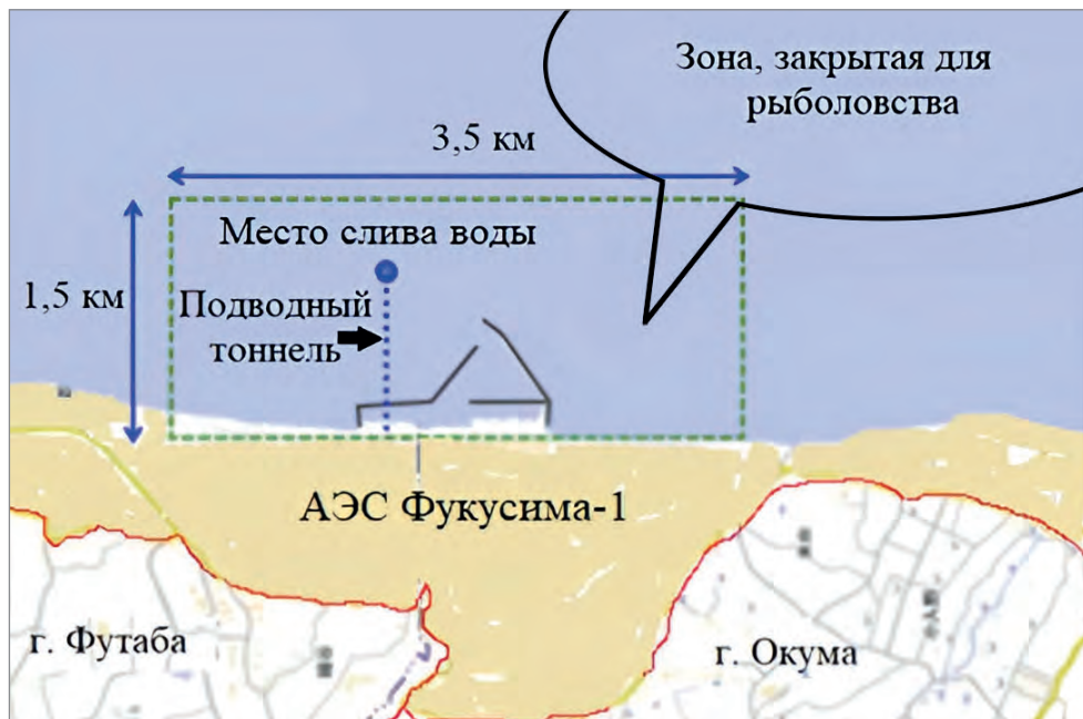
Рис. 2. Длина тоннеля около 1 км, диаметр 2,5 м, пролегает он на 12 м ниже уровня моря
