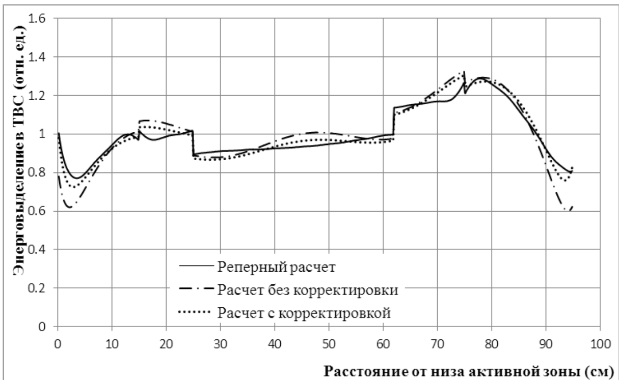
Рисунок 6 - Аксиальное распределение энерговыведения в ТВС из полномасштабных усовершенствованных расчетов с 5 гармониками
