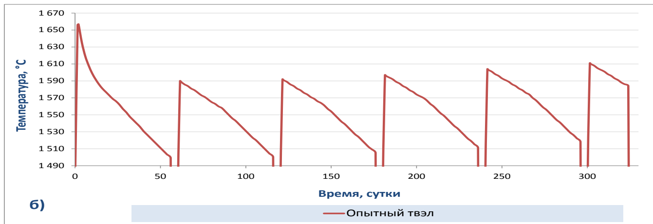
Рисунок 10 – Центральная температура топлива ОТ и ПТ (средняя плоскость топливного столба): а) температуры ОТ и ПТ, б) температура ОТ подробно
