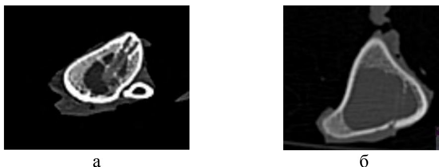
Рисунок 10 – Компьютерная томография костного блока с винтом из композита поли(L-лактида), наполненного 5 вес.% ТКФ, (а) и поли(D,L-лактида) (б) через 12 месяцев резорбции.
