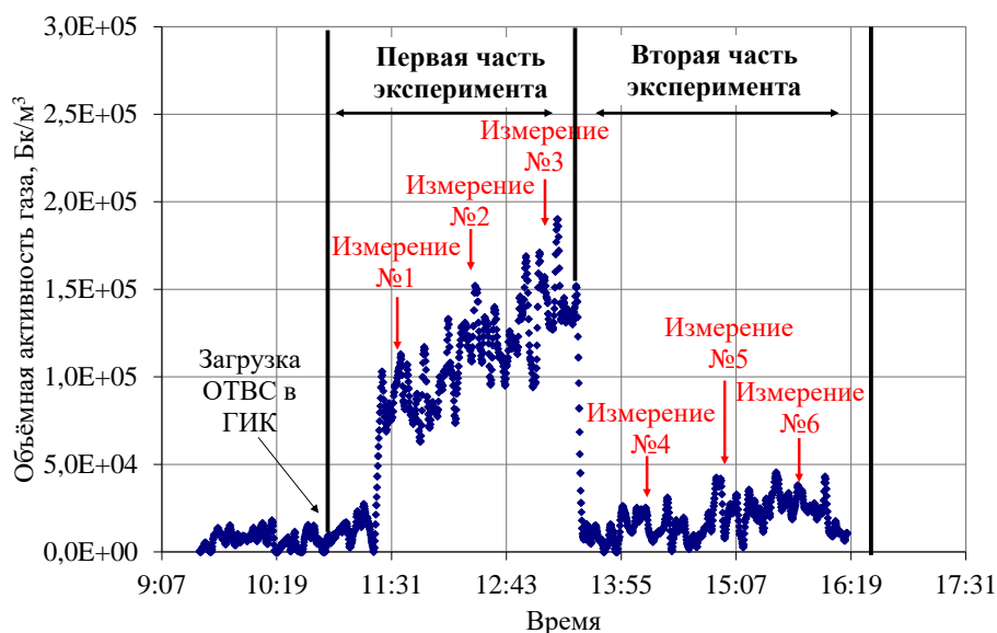
Рисунок 6 – Изменение объёмной активности газа в ИК при экспериментах с ОТВС
