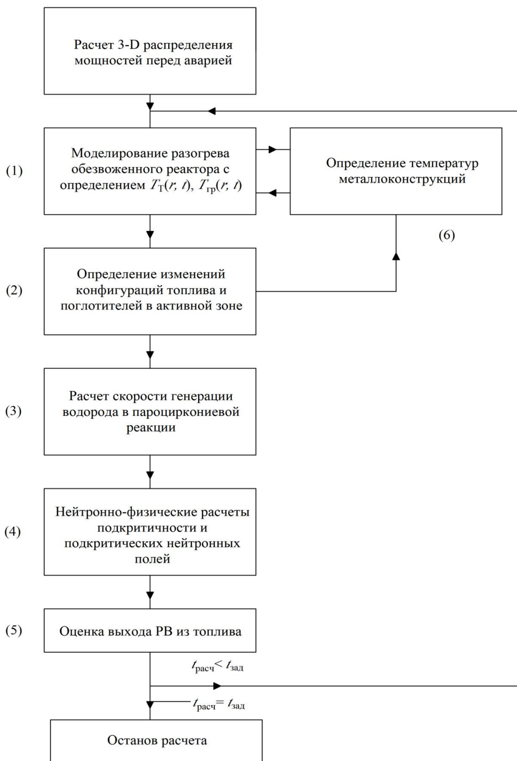
Рисунок 2.2.1 - Блок-схема программы для ЭВМ STEPAN-T
