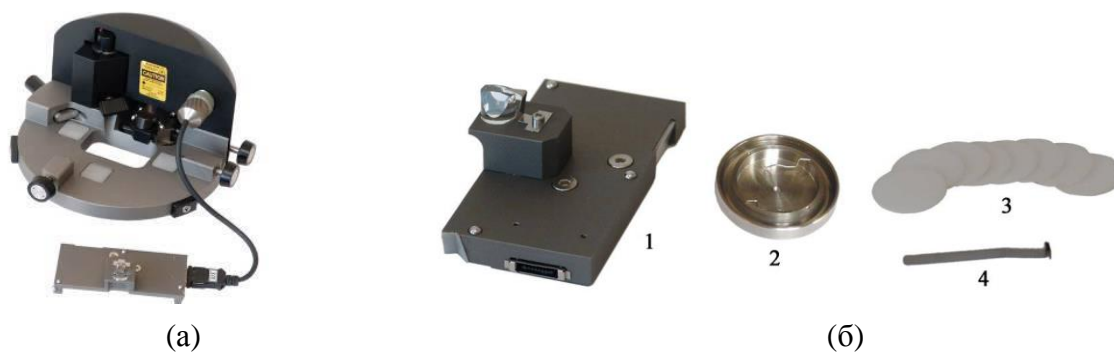
Рисунок 1.17. Универсальная измерительная головка с юстировочным столиком модели AU028NTF с открытой жидкостной ячейкой, (а) – общий вид, (б) - комплект частей юстировочного столика 1 – юстировочный столик; 2 – открытая жидкостная ячейка; 3 – подложки; 4 – ключ.
