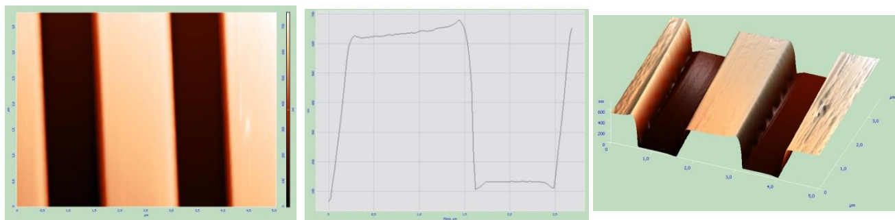
Рисунок 1.20. Изображение калибровочной решетки TGZ3 в жидкости в процессе калибровки. Период решетки 2.4 мкм, высота ступеньки 533 нм.
