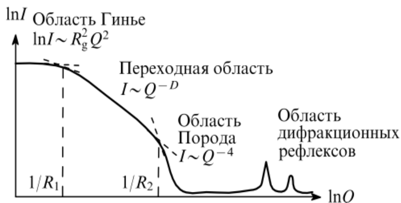
Рисунок 1.15. Общий вид кривой МУРР на неоднородном объекте (на рисунке Q=q – вектор рассеяния) [94]. R_1 – радиус агрегатов, R_2 – радиус частиц, составляющих фрактальный агрегат, R_g – радиус инерции агрегата, D – фрактальная размерность.
