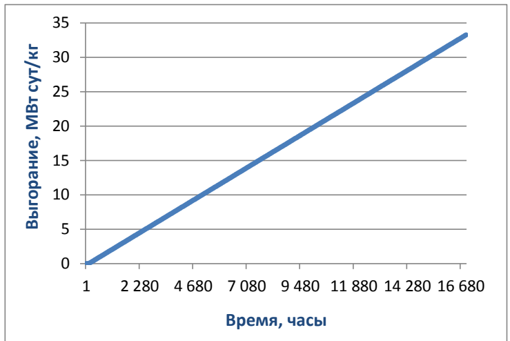
Рисунок 5.5 - Выгорание топлива в ATF-твэле
