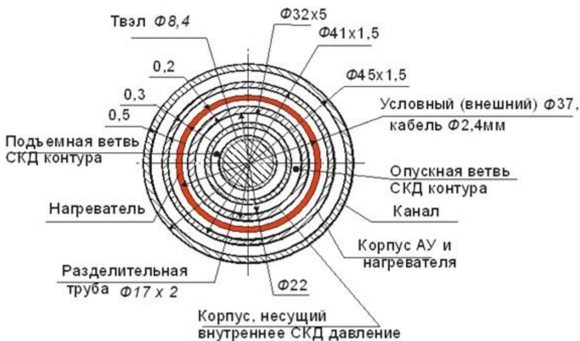
Рисунок 3.5. Один из вариантов схемы сечения АУ для ячейки реактора б-4 с защитным блок-экраном из вольфрама (Все размеры справочные, были взяты для проведения теплогидравлических оценок, и могут быть изменены в процессе разработки АУ)
