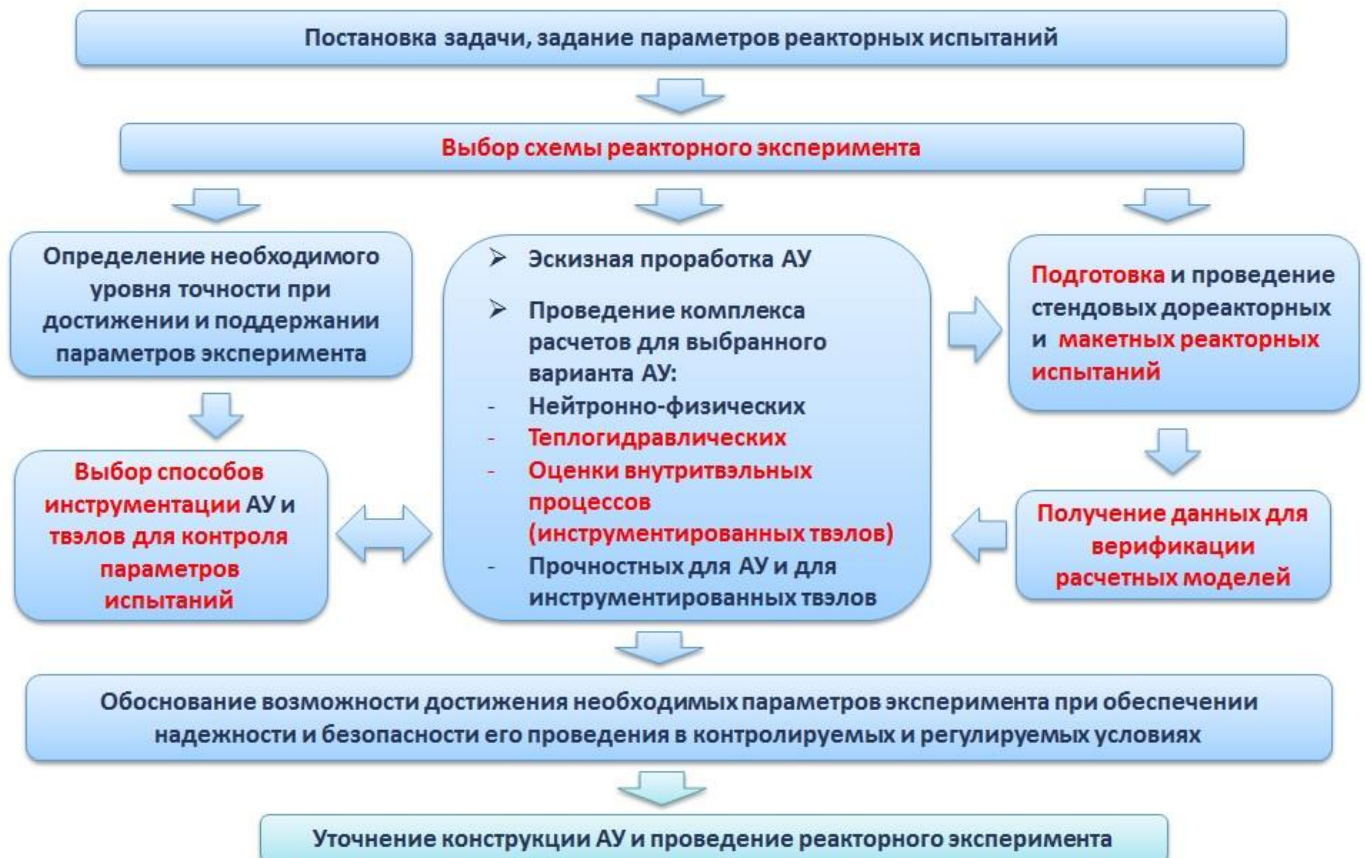
Рисунок 1.13. Схема обоснования представительности экспериментов с опытными твэлами в реакторе ИР-8
