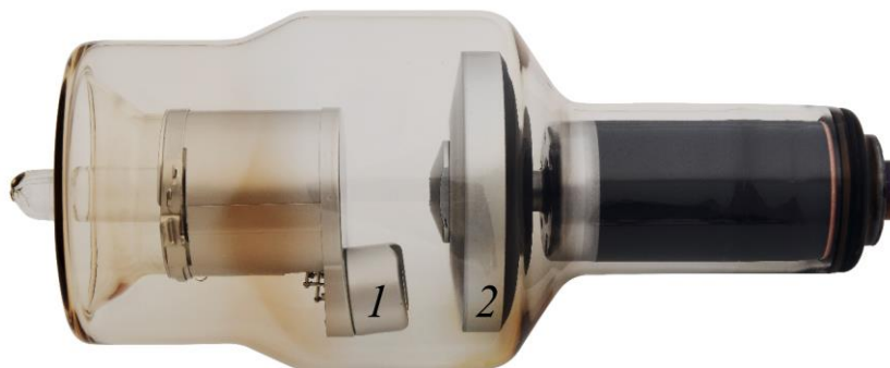
Рис. 1.5. Фото рентгеновской трубки с вращающимся анодом Canon XRR-3352 [22]. Цифрами 1 и 2 отмечены катод и анод.
