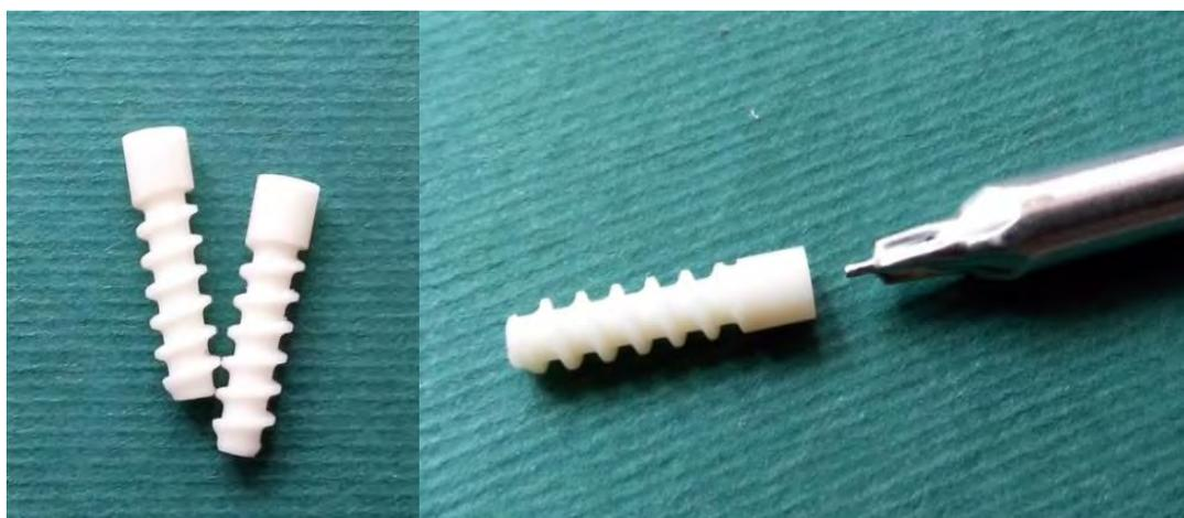
Рисунок 5.1 – Фотографии винтов и инструмента для вкручивания, длина винта 15 мм, диаметр 4 мм
