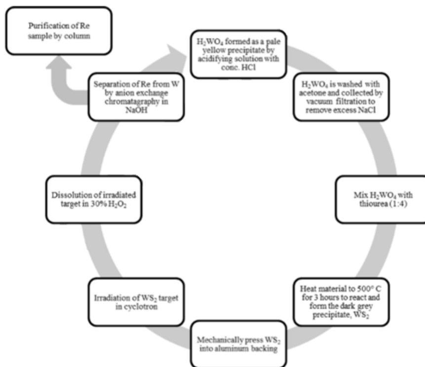
Рисунок 1.13. Схема выделения рения из облученной сульфидной вольфрамовой мишени и регенерации мишенного материала [46]
