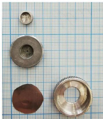
Рисунок 2.4. Мишенное устройство для облучения порошка вольфрама
