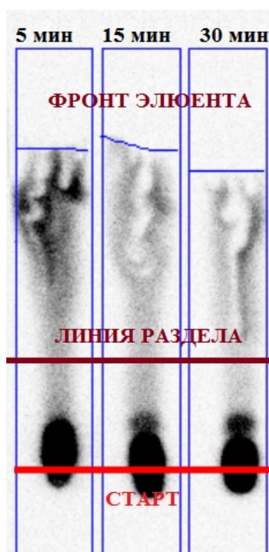
Рисунок 4.1. Разделение свободной и связанной фракции ^{210}\text{Pb} (пластины с образцами по временам инкубирования – 5, 15 и 30 мин)
