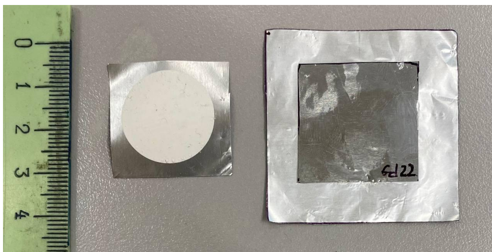
Рис. 35. Мишень ^{nat}\text{Gd}_2\text{O}_3 толщиной 10 \text{ мг/см}^2 , нанесенная на алюминиевую подложку толщиной 20 \text{ мкм} с покрытием из алюминиевой фольги толщиной 8,3 \text{ мкм} и без него
