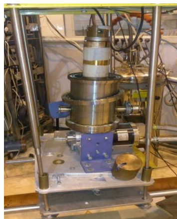
Рисунок 3.4 – Низкотемпературная приставка и криокулер на станции «Структурное материаловедение»
