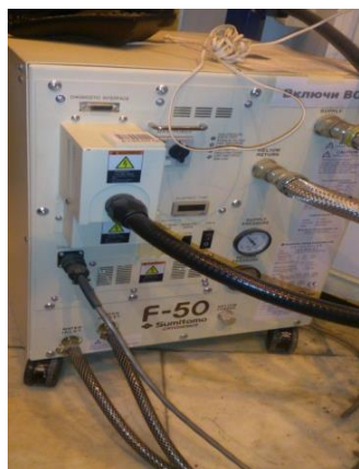
Рисунок 3.4 – Низкотемпературная приставка и криокулер на станции «Структурное материаловедение»
