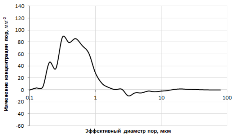
Рисунок 4.15 – Изменение концентрации пор после теста на дроспаемость, уран-гадолиниевых таблеток с 5 мас.% Gd_2O_3 экспериментальной партии №1-1-2
