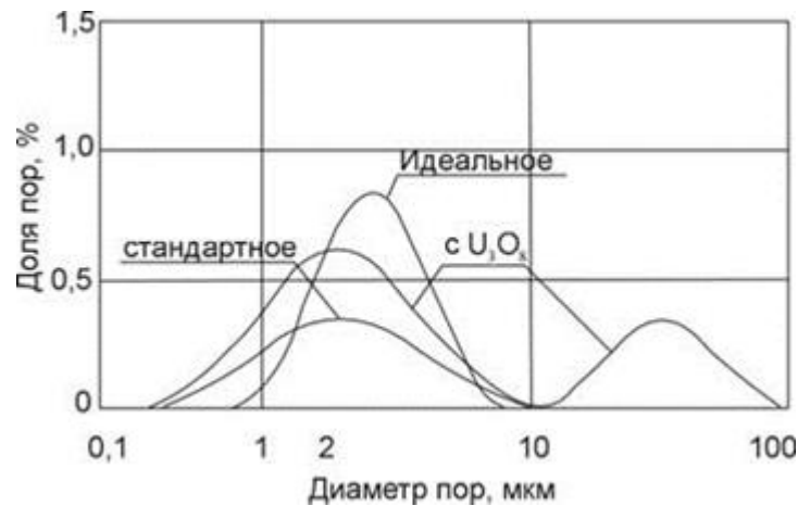
Рисунок 2.3 - Изменение распределения пор по размерам в зависимости от способа изготовления таблеток
