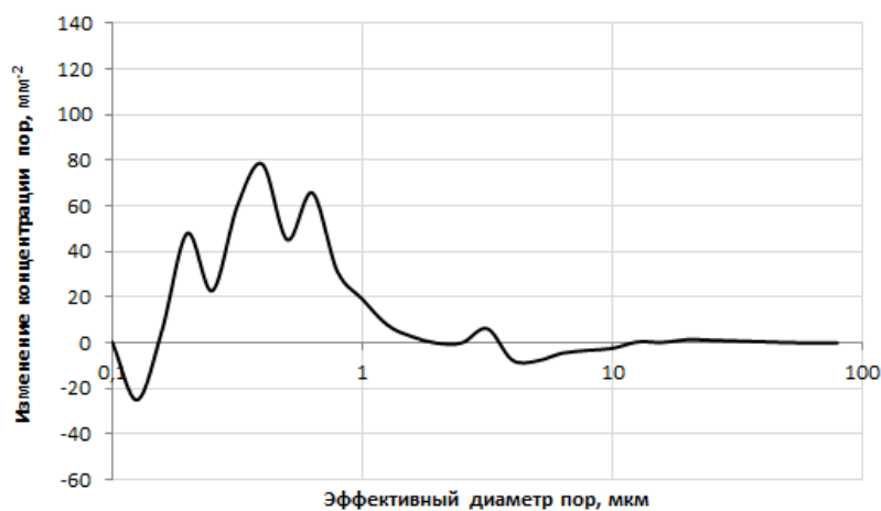
Рисунок 4.18 – Изменение концентрации пор после теста на дроспаемость, уран-гадолиниевых таблеток с 5 мас.% Gd_2O_3 экспериментальной партии №2-1-1
