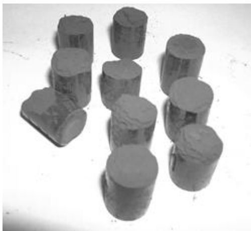
Рисунок 1.18 – «Сырые» таблетки с отслоением торца
