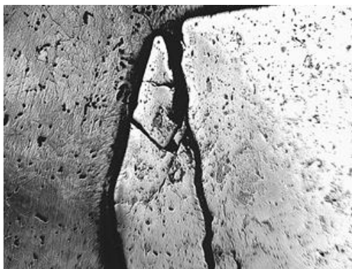
Рисунок 1.17 – Пример расслойной трещины (расстояние от торца \leq 1,5 мм)
