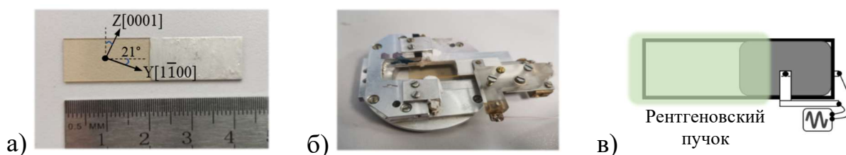
Рисунок 3. Фотографии образца лангасита с нанесенными электродами (а) и образца в кристаллодержателе (б). Схема подачи сигнала и область засветки кристалла (в).
