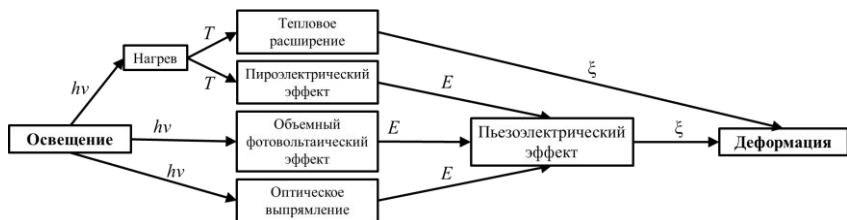
Рисунок 1. Схематическое представление процессов формирования деформаций \zeta в нецентросимметричных кристаллах при освещении на примере НЛ; h\nu – энергия квантов света, T – температура, E – электрическое поле.
