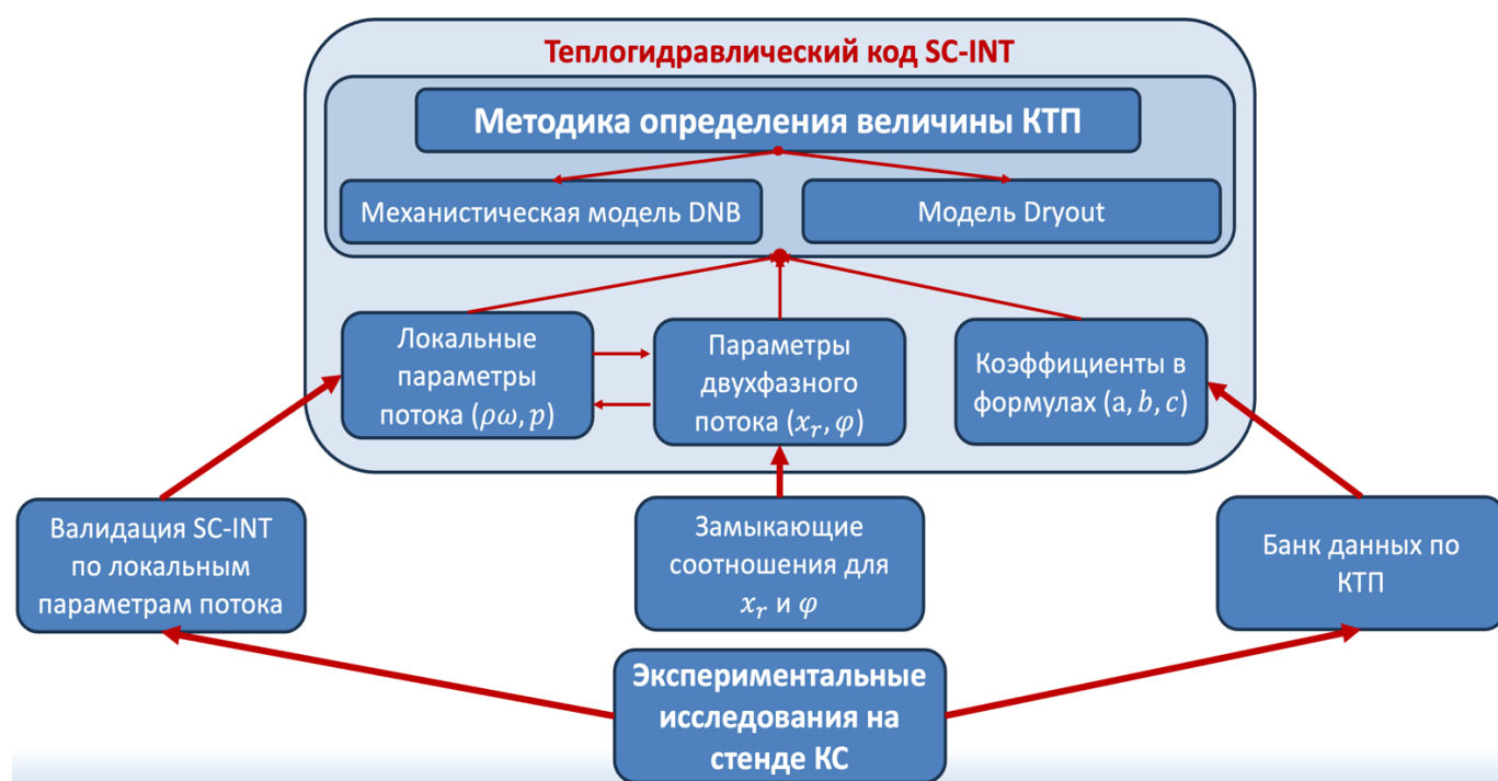
Рис. 3. Общая структура универсальной методики определения величины КТП, ее составных частей и экспериментальных исследований, направленных на поддержку ее валидации
