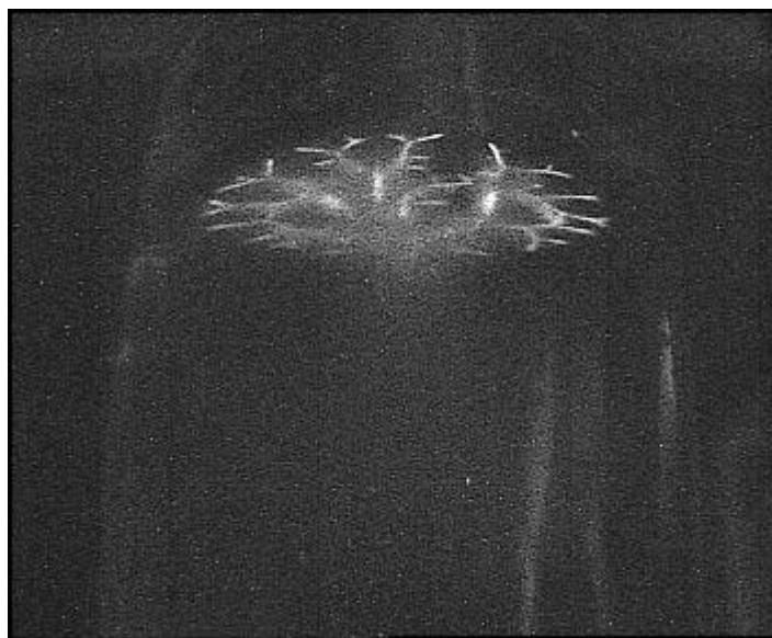
Рис. 2.7.4. Сетка из светящихся пузырьков на поверхности УЗ волновода.
