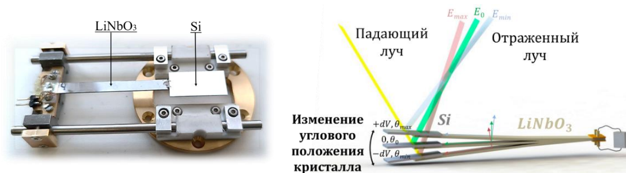
Рисунок 1.11. Изгибный АЭРО на основе монокристалла \text{LiNbO}_3 : фотография элемента (слева), принцип работы колеблющегося элемента (справа).
