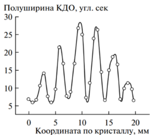
Рисунок 4.5. Распределение полуширины кривой дифракционного отражения при включенном продольном УЗ, отражающее распределение амплитуды деформации для составного резонатора \text{SiO}_2 + \text{Ge} .
