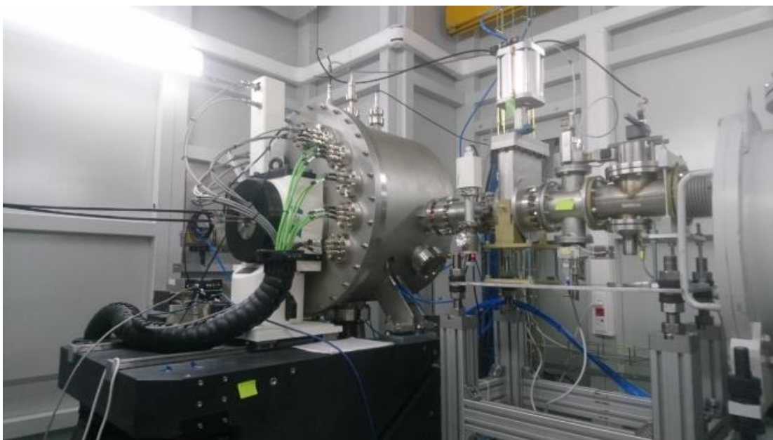
Рисунок 10 – Внешний вид вакуумной камеры двухкристального монохроматора станции «РСА». После монохроматора установлен затвор, отделяющий его от камеры с зеркалом, и монитор положения пучка
