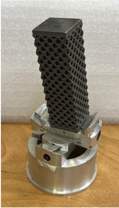
Рисунок 3.15 – Образец со сложной внутренней сетчатой структурой, размещенный на двух сегментах качания под углом 6^\circ относительно оси вращения
