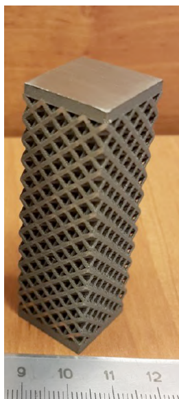
Рисунок 3.12 – Образец со сложной внутренней сетчатой структурой, изготовленный методом селективного лазерного плавления (СЛП) из стали марки CL20es
