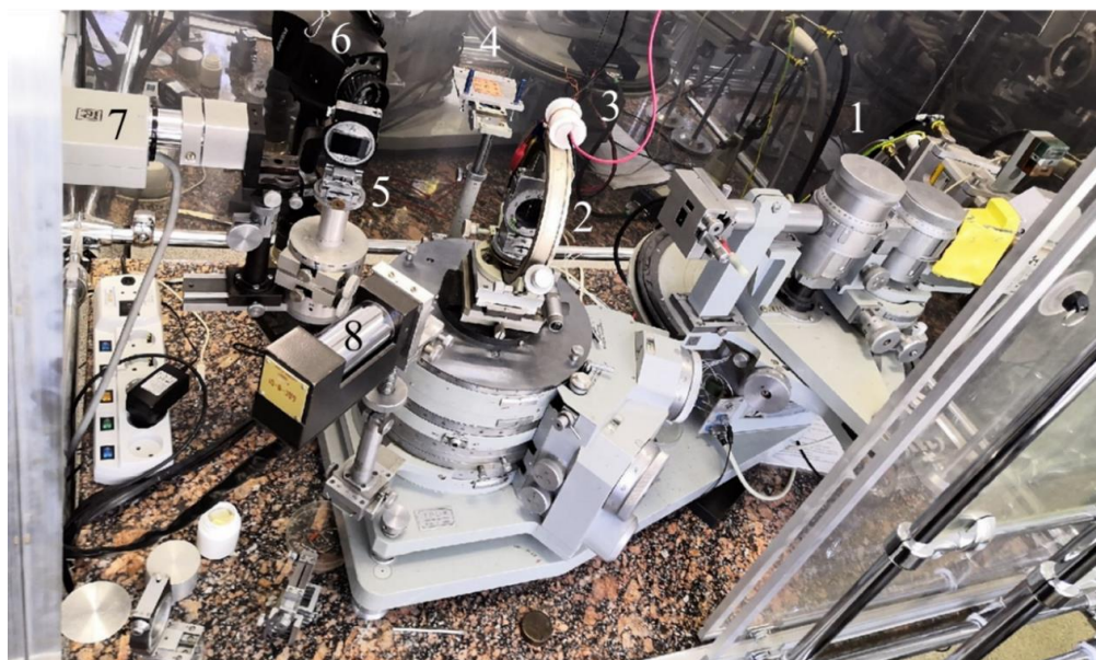
Рисунок 3.2 – Фотография экспериментальной установки ТРС-К на ранних этапах модернизации: (1) – источник рентгеновского излучения с кристаллом-монокроматором и выходной щелью, (2) – кристаллодержатель, установленный на гониометрической системе, (3) – контакты для подведения внешнего электрического поля от высоковольтного источника, (4) – стойка для установки излучателя лазера, (5) – выдвижной кристаллодержатель с высокосовершенным монокристаллом кремния для экспериментов в трехкристальной схеме, (6) – тепловизор, (7) и (8) – сцинтилляционные детекторы.
