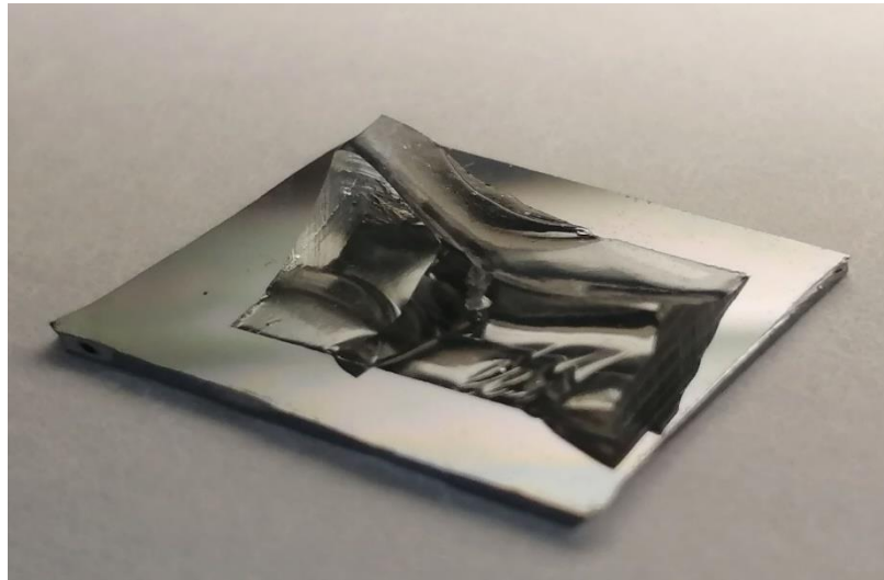
Рисунок 91 – Результат испытания адгезии ПДМС к SU–8 при оптимальных параметрах обработки в азотной плазме
