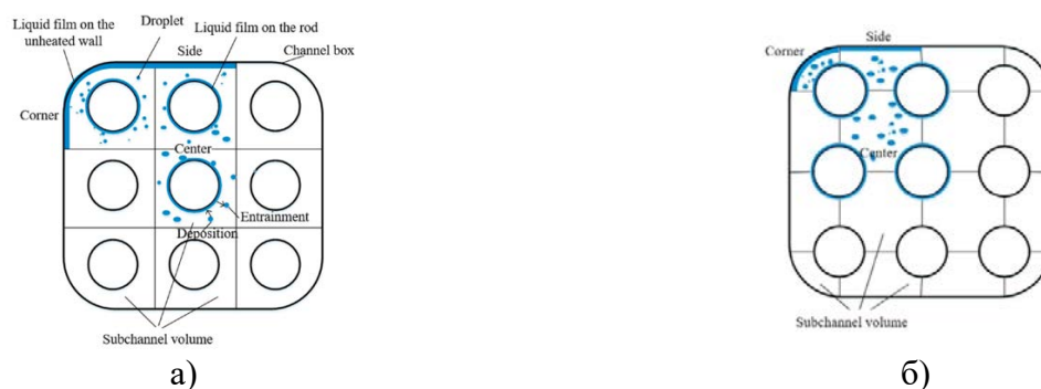
Рисунок 3.8 – Схематические изображения а) твэл-центрированных и б) теплоноситель-центрированных расчетных сеток [217]
