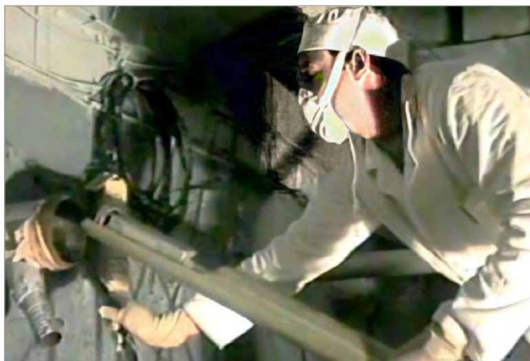
Рис. 22. Сотрудник Курчатовского института у скважины со штангой, на которой укреплен дозиметр, 1988 год
