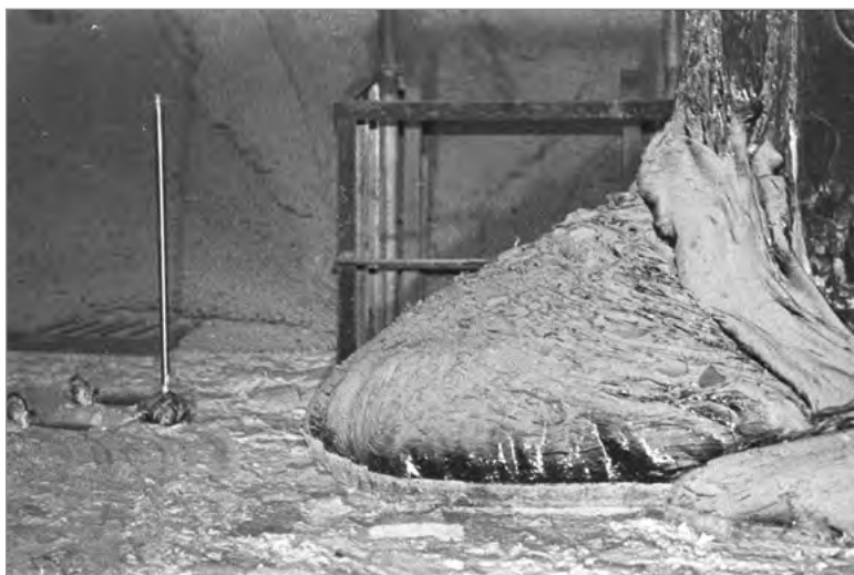
Рис. 13. «Слоновья нога» — топливная лава, застывшая в виде гигантской капли в пом. 217/2
