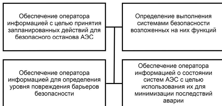
Рис. 1. Назначение параметров измерения объёмной активности ИРГ при управлении АЭС
