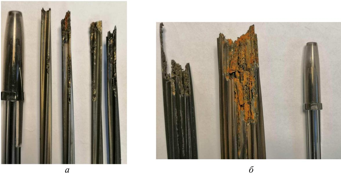
Рис. 6. Характер разрушения твэлов при кризисе теплообмена: *а* — одиночные твэлы; *б* — пучки твэлов
