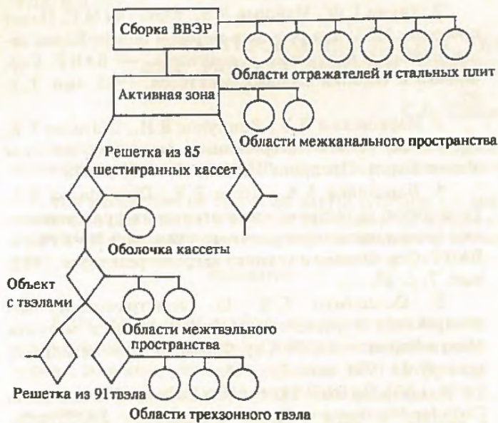
Рис. 3. Граф экспериментальной сборки (часть графа не показана): ○ — области; □ — объекты; ◇ — объекты — элементы решеток
