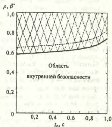
Р и с. 7. Зависимость предельной величины амплитуды вводимой положительной реактивности \rho_0 от времени ее ввода t_0 , при которой следующий за этим рост мощности реактора не приводит к его аварии в течение 1 с: — — — в отсутствие радиального перемешивания теплоносителя; — — — в предположении его полного перемешивания
