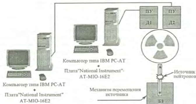
Рис. 7. Блок-схема технического комплекса для измерения реактивности: ПУ — предварительный усилитель; Д1 и Д2 — детекторы нейтронов; БЗ — биологическая защита
