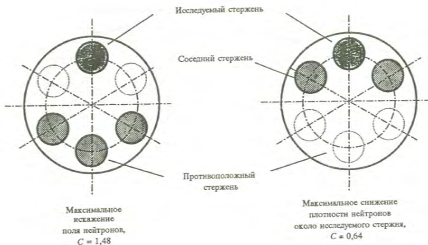
Рис. 3. Пределы изменения интерференционных коэффициентов отдельного стержня управления
