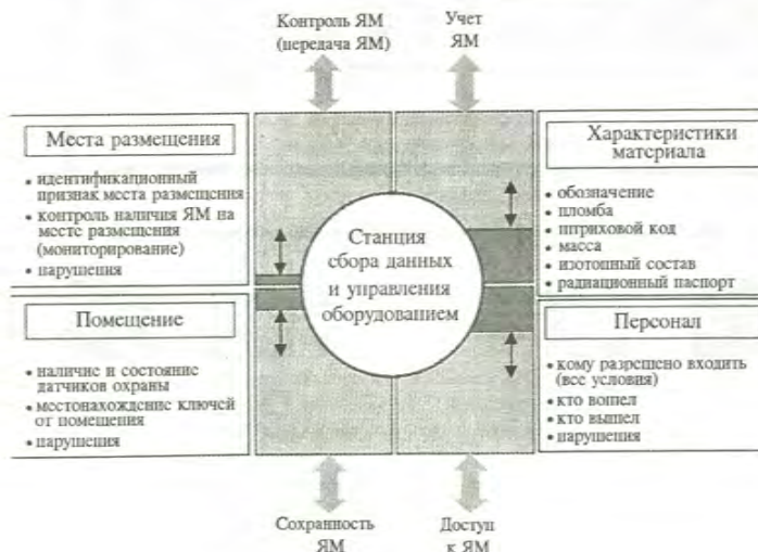
Рис. 5. Задачи станции сбора данных и управления оборудованием
