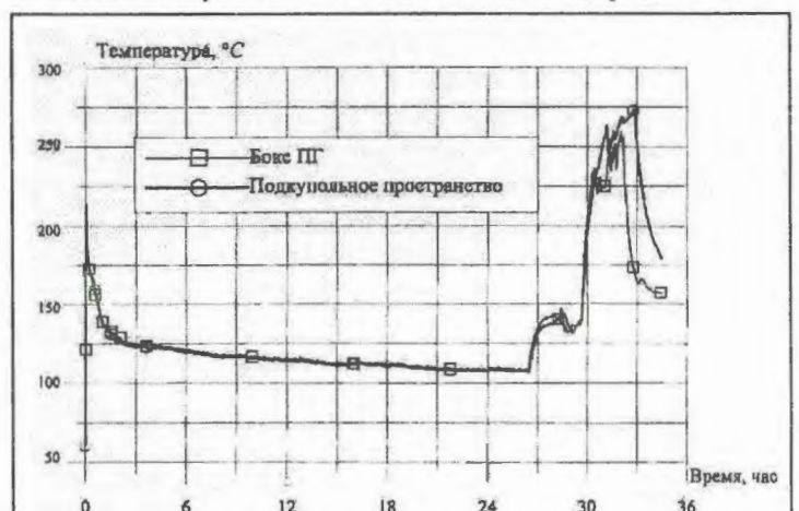
Рис. 8. Изменение температуры среды в боксе аварийной петли и в объеме подкупольного пространства с учетом работы рекомбинаторов системы дожигания водорода
