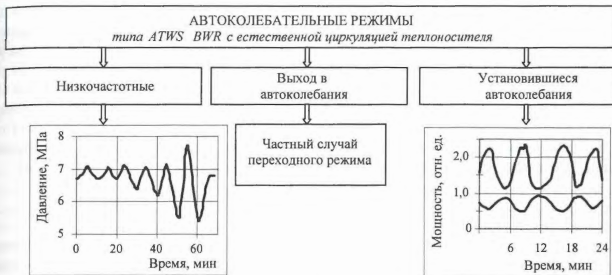
Рис. 3. Основные типы автоколебательных режимов РУ ВК-50
