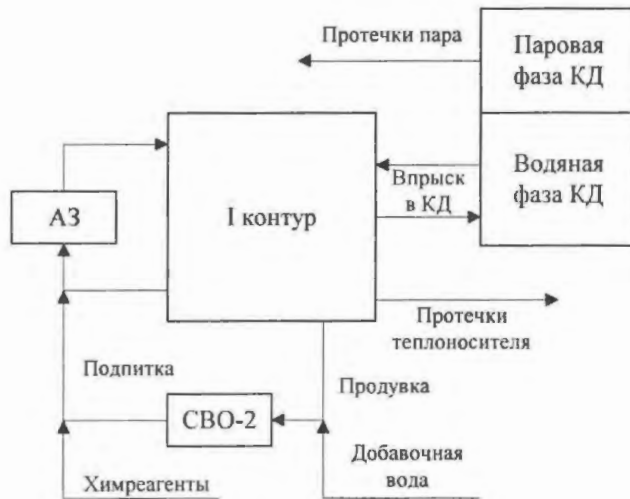
Рис. 1. Гидравлическая схема расчета выхода газов при работе на мощности
