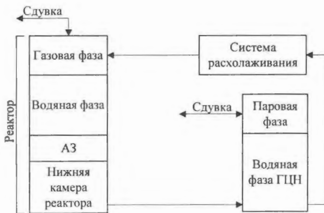
Рис. 3. Гидравлическая схема расчета выхода газов при ремонтном расхолаживании
