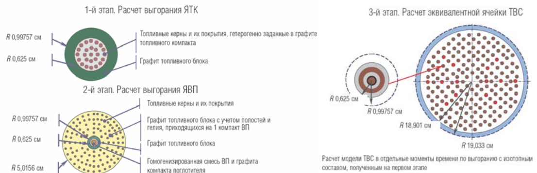
Рис. 9. Поэтапный подход к расчету ячейки топливного блока
