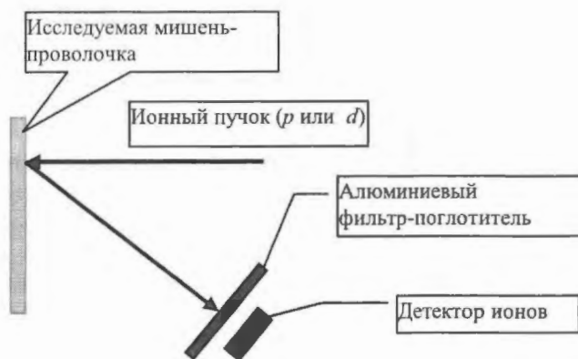
Рис. 1. Схема установки для использования метода ядерных реакций
