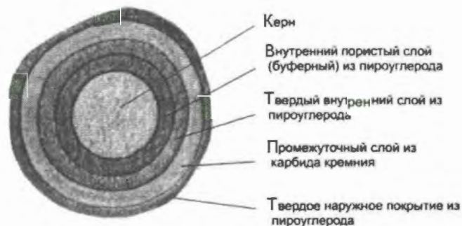
Рис. 1. Шлиф-разрез микровэла
