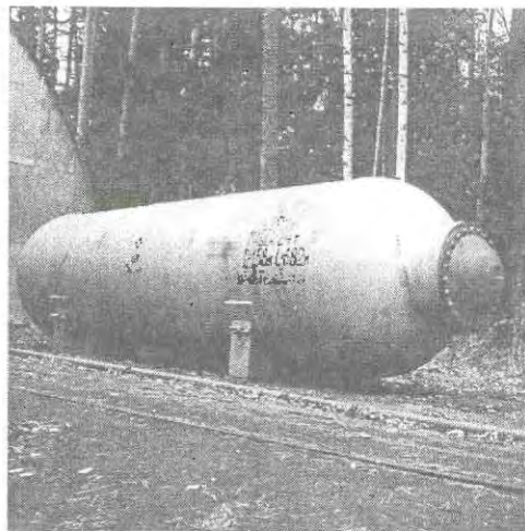
Рис. 8. Взрывозащитная камера для реактора РИР
