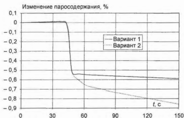
Рис. 4. Изменение паросодержания при измерении ПКР. Здесь приведены две временные зависимости среднего по активной зоне паросодержания: вариант 1 – изменение паросодержания только за счет изменения расхода питательной воды ( \Delta\phi_{пв} ); вариант 2 – суммарное изменение паросодержания за счет изменения расхода питательной воды и тепловой мощности реактора ( \Delta\phi = \Delta\phi_{пв} + \Delta\phi_w )
