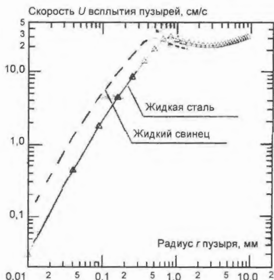
Рис. 4. Изменение скорости U всплытия газовых пузырей в зависимости от радиуса r пузыря в жидких свинце и стали
