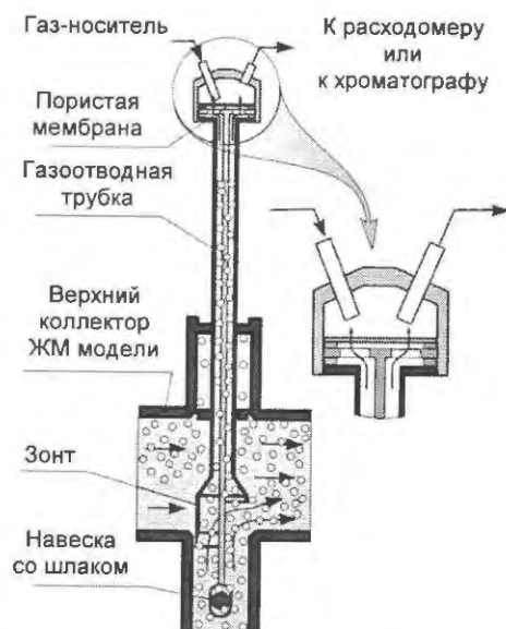
Рис. 11. Схема отбора газа из рабочего участка стенда СВТ-3М через газотводную трубку. Расположение навески с образцом оксида свинца
