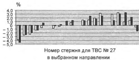
Рис. 3. Отличия усредненных по топливным стержням скоростей реакции деления внутри ТВС № 27 в расчетах SUH-6 от значений, рассчитанных по программам MCNP (ряд 1 – □) и MCU (ряд 2 – ■) для диагонального направления от нижнего левого стержня (угла) к верхнему правому стержню (углу)
