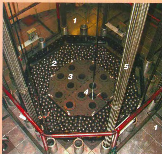
Рис. 2. Фотография критической сборки с кольцевой активной зоной: 1 – графитовый БО с верхними крышками; 2 – кольцевая активная зона; 3 – БО из графитовых блоков; 4 – канал для регулирующего стержня КО7; 5 – стержень АЗ4
