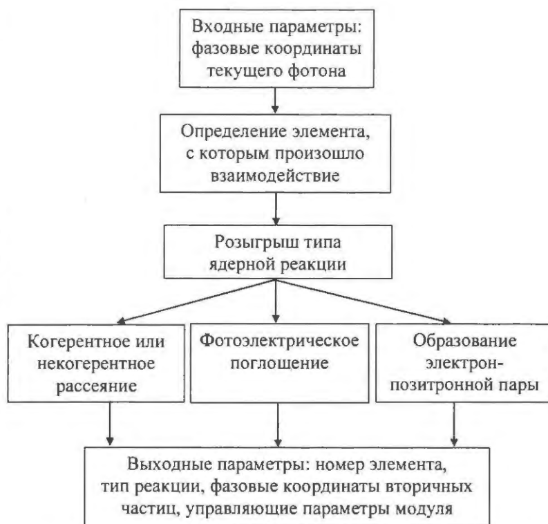
Рис. 3 Упрощенная схема моделирования взаимодействия фотонов со средой
