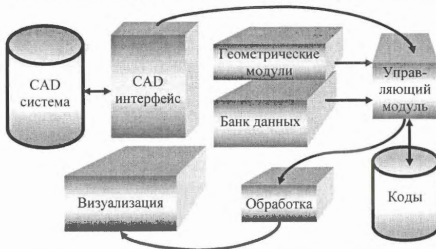
Рис. 3. Объединение стадий проектирования и расчетного моделирования систем
