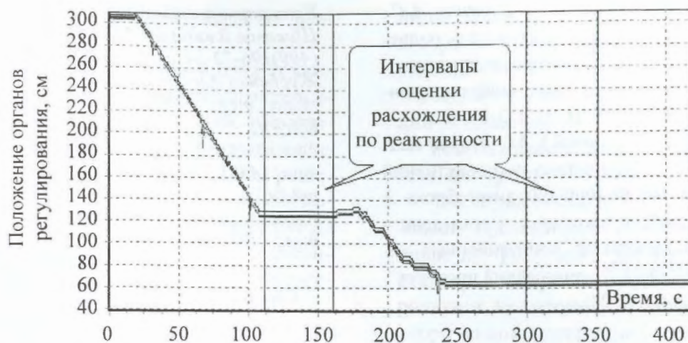
Рис. 5. Перемещение органов регулирования, 10-я группа (типовой график для ВВЭР-1000)
