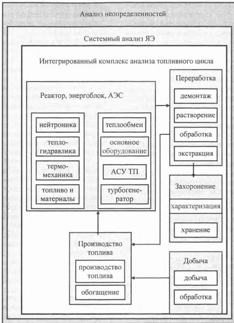
Рис. 2. Схема полномасштабного программного комплекса моделирования топливного цикла
